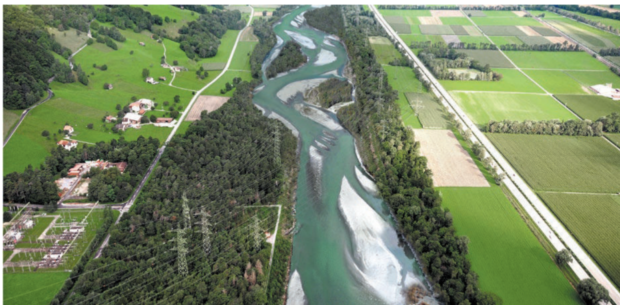
Fotomontage der Aufweitung Maienfeld / Bad Ragaz, mit einer möglichen Flussentwicklung nach dem Ausbau und 174 m Flussbreite.
